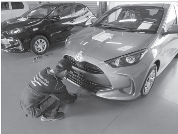
Fig. 7 エーミング作業風景①
