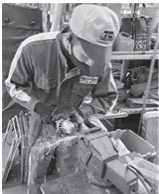
Fig. 7 アンカー製作
