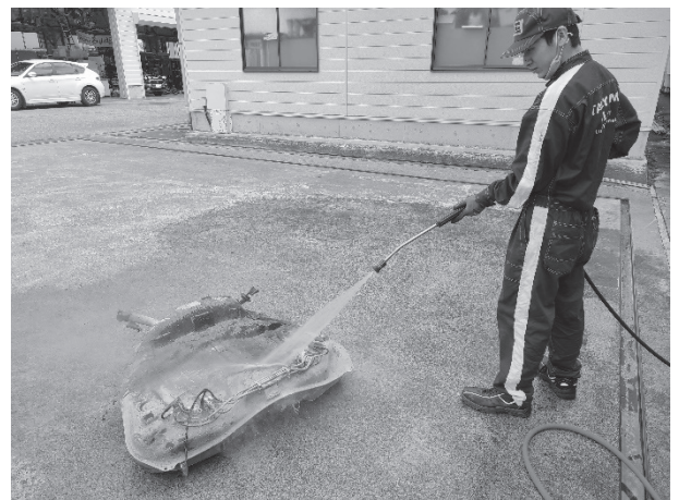
Fig. 5 燃料タンク洗浄
