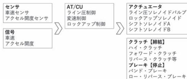
図3-1 電子制御式4速ATのシステム図
