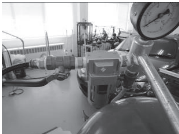
図6 サンドブラスター空気圧調整用ボールバルブ
