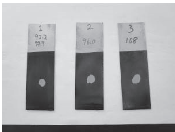
図15 サンドブラストを行った試験片
