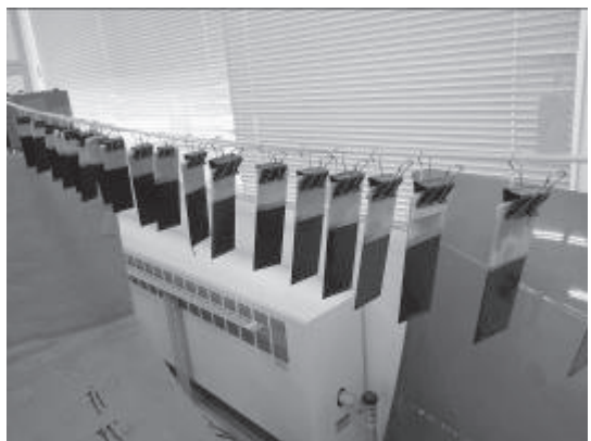
図14 試験片塗装後の乾燥
