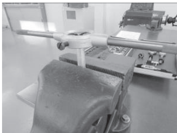
図5 配管のねじ山修正
