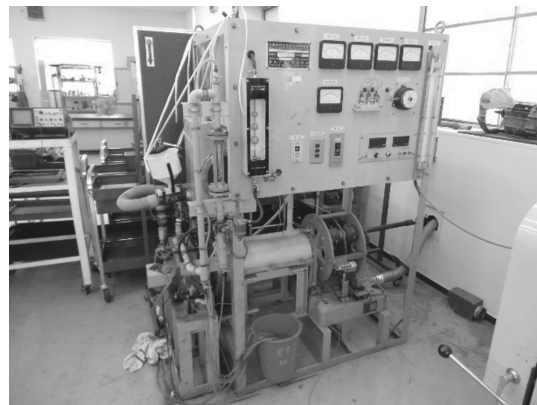
図 1 実験装置写真（エンジン性能試験装置全体図）
