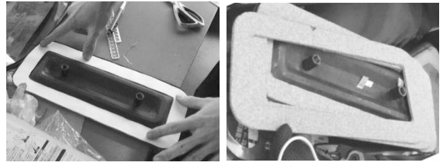
Fig.11 製作したサイド・カバー・ガスケット (右)
