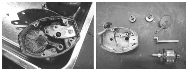
Fig.14 修繕前・修繕後のワイパ・モータ
