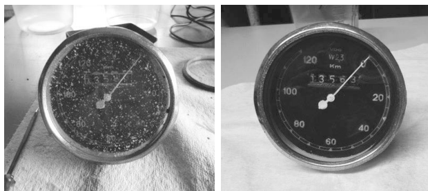
Fig.16 修繕前・修繕後のスピードメータ
