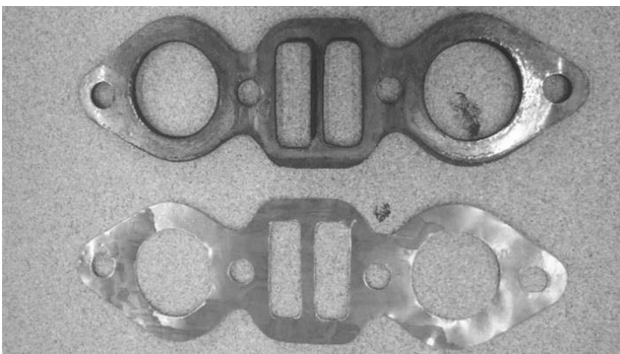
Fig.9 使用されていたマニホールド・ガスケット (上) 製作したマニホールド・ガスケット (下)
