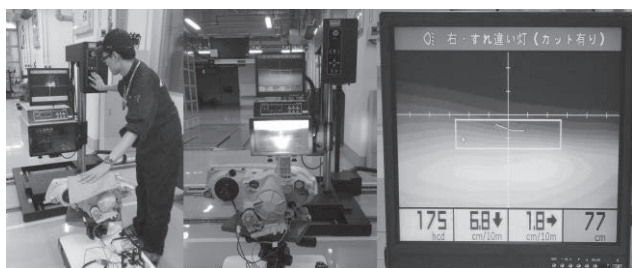
Fig.7 ディスチャージ・バルブの測定の様子
