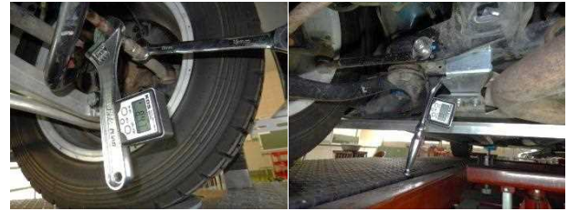
図11 部品調整量に対するトー変化量調査
