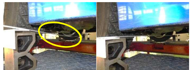
図4 コンベックスの弛み (左：弛み有り、右：弛み無し)
