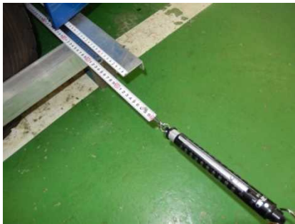
図6 張力によるコンベックス弛み量調査
