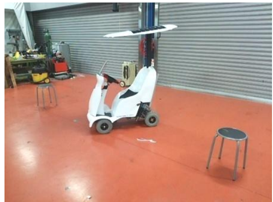
図 4-4 動的車両安定性実験 (8 の字走行)
