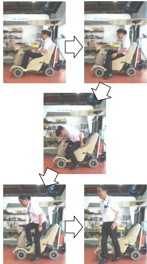
図 4-1 走行モード時の降車動作
