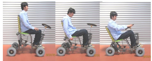
図 2-3 乗降モードから走行モードへの変形
