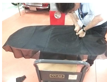
図 3-5(b) ルーフ内張り加工
