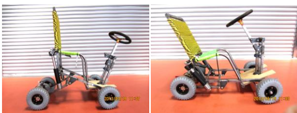
図 2-2 フレーム 乗降モード (左)，走行モード (右)
