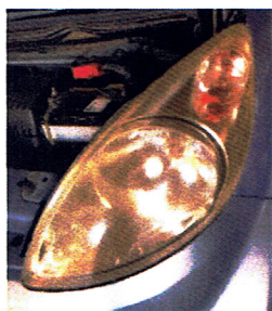
図 7 前照灯レンズ表面の劣化による黄ばみ
