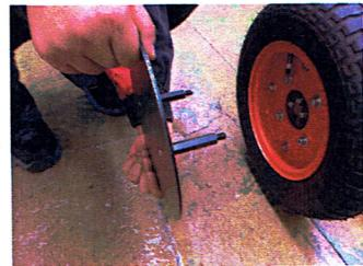
図5 テスター取付け用車輪ジグ
