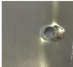
図 6 ボタン破断したアルミニウム合金板 溶接条件 : 10.0kA, 1.00kN, 2.00s)
