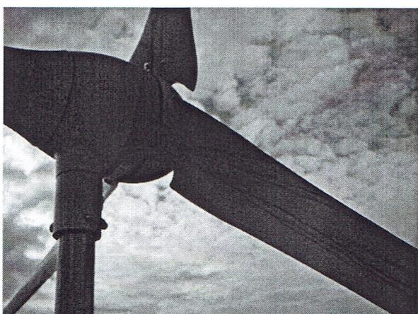
図 22 ブレード取り付け部の汚れ
