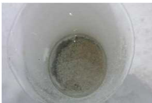
Fig.2 塩化ナトリウムの融雪効果
