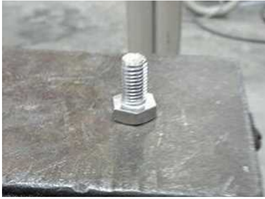
Fig.5 供試ボルトの外観
