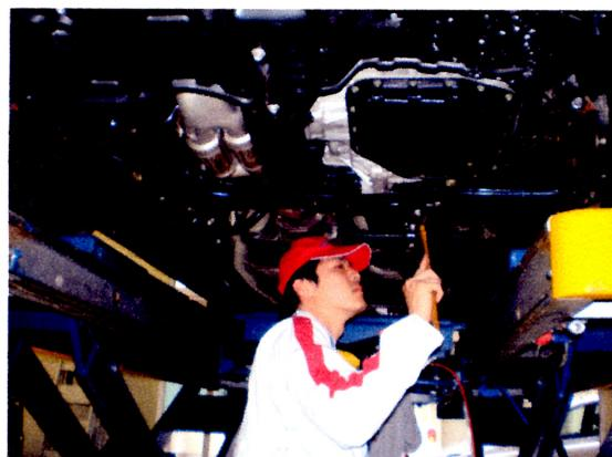
図9 リフトアップされた実験車の打音検査
