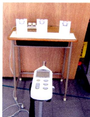
図11 ブザーを用いた音圧レベル加算の実験
