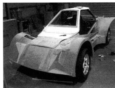
図5 ベニヤ板成形完成状態
