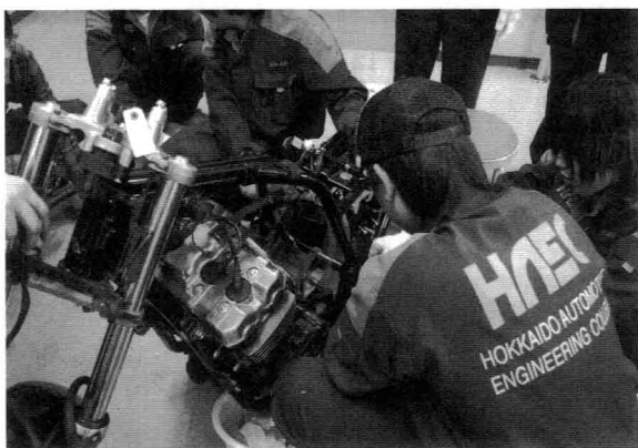
Fig 6 バイクからエンジン取り外し
