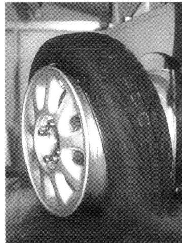
図10 タイヤ試験装置上でタイヤのビードが離脱した瞬間
