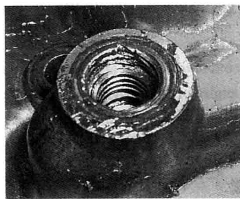
図12 オイルフィルタブラケット損傷
